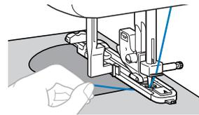
► Cuando termine la costura, la máquina coserá automáticamente una costura de remate y se detendrá.
