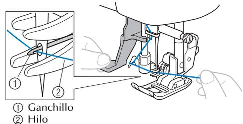
**5** Suelte la palanca del enhebrador de aguja. A continuación, tire del lazo de hilo.
