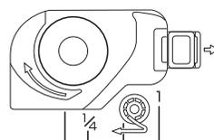
**1** Suba la aguja a la posición más alta girando la rueda hacia usted (hacia la izquierda) o pulse **[+]** (botón de Posición de aguja) (para los modelos equipados con el botón de Posición de aguja) y suba la palanca del pie prensatela.
