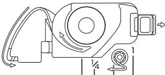
**1** Suba la aguja a la posición más alta girando la rueda hacia usted (hacia la izquierda) o pulse **+** (botón de Posición de aguja) (para los modelos equipados con el botón de Posición de aguja) y suba la palanca del pie prensatela.
