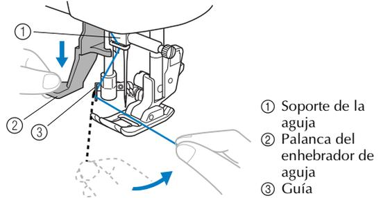
**4** Baje completamente la palanca del enhebrador de aguja.
