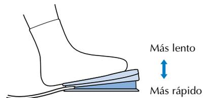
Debe asegurarse de que no haya nada sobre el pedal cuando la máquina no esté en uso.
