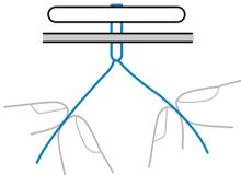
**11** Una vez colocado el botón, deslice la palanca de posición de los dientes de arrastre hasta la posición
